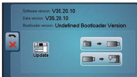
5.6. Der Update Vorgang wird gestartet und dauert einige Minuten. Während des Updates die Maschine NICHT ausschalten und den USB-Memory Stick NICHT entfernen.
