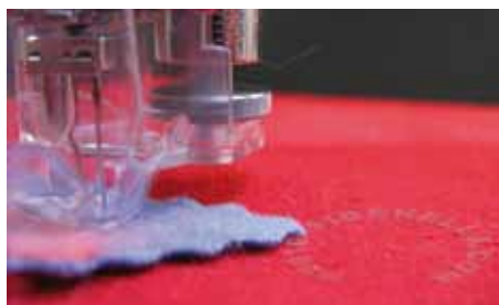
Niedrige Fussposition bei Stufe 1
