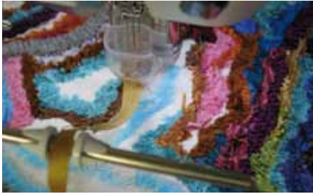
Das Nähprojekt zurecht drücken für enge oder weite Nadelwege.
