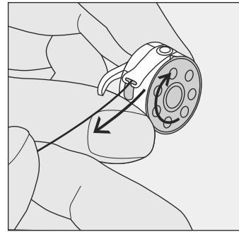
..... чтобы она вошла в Т-образную прорезь на конце пружинки. Шпулька должна вращаться по часовой стрелке.
