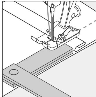
вплотную придинув к игле. Шейте до тех пор, пока вся лапка не перейдет через утолщение материала. После этого удалите пластиинки.
