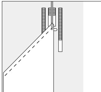
При обшивании уголка транспортер плохо перемещает материал, так как с зубьями транспортера соприкасается только часть материала.
