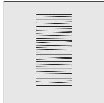
Подтягивание или подталкивание материала вызывает "пробелы", а удерживание приводит к образованию "узелков".
