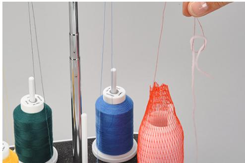
> Eingefädelten Faden durch die Nadel nachziehen, bis der neu verknotete Faden vor dem Nadelöhr liegt.
