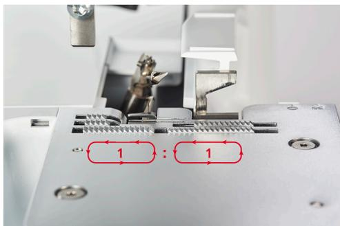
Die Maschine erzielt mit dem Grundwert 1 bei den meisten Anwendungen ein optimales Nähresultat. Differenzialtransport in Grundeinstellung 1 für flache und gleichmässige Nähte.
