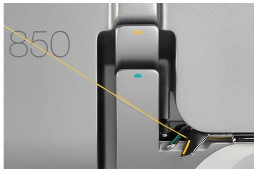
> Faden über die Nadel-Fadengeberabdeckung legen und nach unten ziehen.
