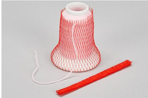
> Spulennetz von oben über die Fadenspule stülpen und das Fadenende nach oben ziehen.
