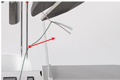
> Restfaden aus dem Nadelöhr entfernen.
