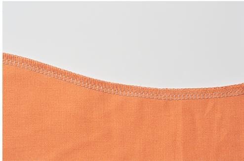
Innenrundungen kommen an Halsausschnitten, Besätzen und Armausschnitten vor. Mühsames Ein- oder Zurückschneiden kann vermieden werden, wenn diese Kanten mit einer Overlocknaht genäht werden.
