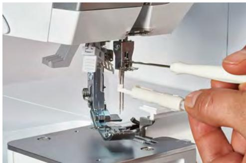
> Retirer l'aiguille par le bas et la déposer dans la boîte à aiguilles ou sur le coussin à aiguilles derrière le couvercle de l'enfileur.
