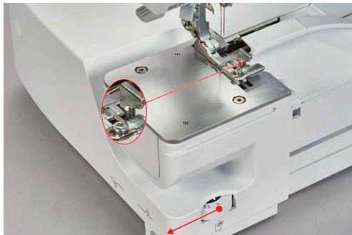
Si la largeur de coupe est changée, le couteau, la tige de point et le recouvrement des boucleurs se déplacent dans le sens correspondant.
