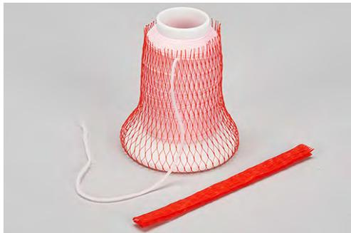
> Mettre le filet de bobine par le haut au-dessus de la bobine de fil et tirer l'extrémité du fil vers le haut.
