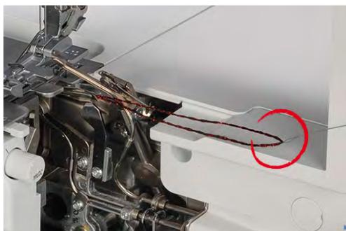
> Mettre les fils de boucleur sous le pied-de-biche vers l'arrière à gauche.
