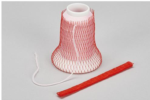
> Colocar a rede para bobinas por cima da bobina e puxar a ponta da linha para cima..
