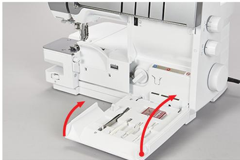
Se não for possível fechar completamente a cobertura do enfiador, o conector On/Off do enfiador pneumático pode ainda estar ligado.
