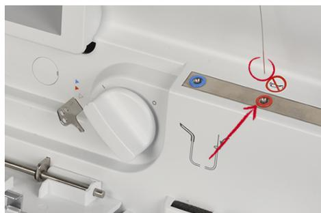
> Coloque a linha da lançadeira pretendida através da laçada do arame de enfiar.
