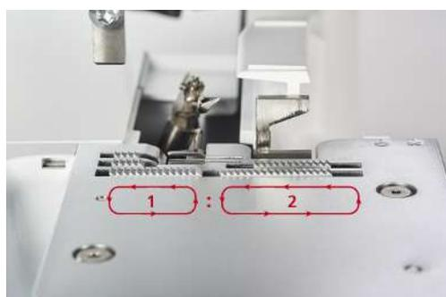
Com uma configuração de 1,5 - 2 o transportador dianteiro (2) percorre uma distância maior que o traseiro (1).
