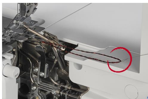
> Coloque as linhas da lançadeira por baixo do calcador, para o lado traseiro esquerdo.
