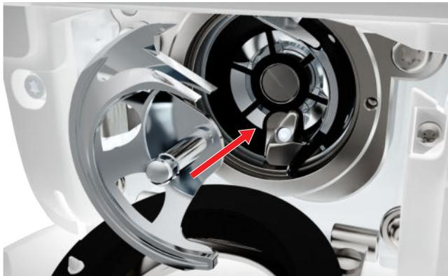
8. フックを挿入し、必要に応じて、フックドライバーが左側に来るまでハンドホイールを回します。
