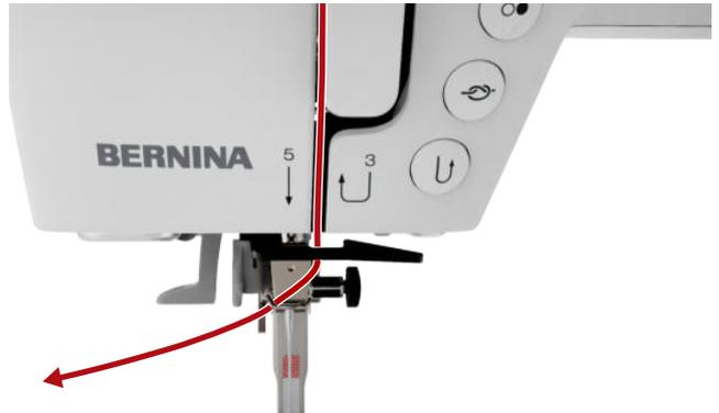
16. 糸通しレバーを半分まで押し下げます。糸を糸通し指の後ろに引っ掛けるようにして通します。
