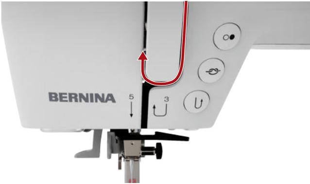
12. 糸を糸取りレバーに通して下方に通します。糸が左側のパネルの下を通っていることを確認します。
