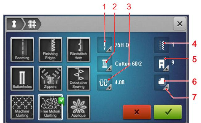
1 推奨針 2 推奨糸 3 推奨上糸調子 4 推奨ステッチパターン 5 推奨押え金 6 推奨安定紙 7 詳細情報
