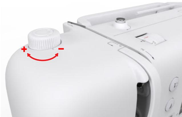
1. 押え圧を下げるには、押え圧回転ノブを反時計回りに回します。
