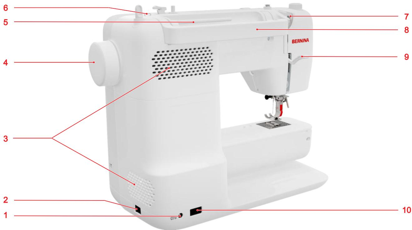
1 Conexão para pedal 2 Interruptor 3 Ranhuras de ventilação 4 Volante 5 Suporte de bobinas, horizontal 6 Olhal de guia da linha 7 Guia da linha, traseira 8 Pega de transporte 9 Alavanca do calcador 10 Ligação do cabo de alimentação
