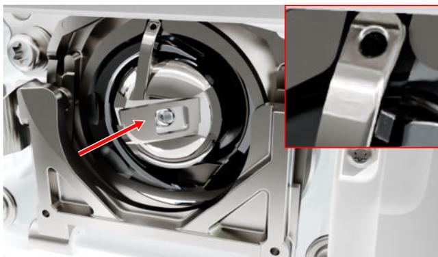
11. Pressione o centro da caixa da bobina até encaixar na devida posição.
