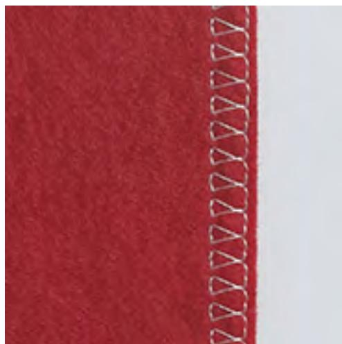
Двойной оверлокный шов подходит для рыхлых трикотажных материалов и в качестве поперечного шва на вязаных изделиях. При шитье трикотажных материалов нужно применять новую иглу «джерси», чтобы не повредить тонкие ячейки материала. При шитье эластичных тканей можно использовать иглу для эластичных материалов.
