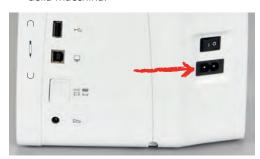
> Inserire la spina del cavo di alimentazione nella presa di corrente.
