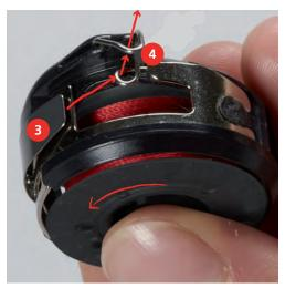
> Per inserire la capsula nella macchina, tenerla in modo che la guida del filo (5) sia rivolta verso l'alto.
