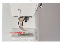
> Abbassare il gambo con l'apposita leva.
