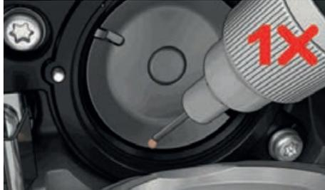
> フェルトが湿るように、ベルニナミシンオイルを二つの油溜りに一滴ずつ注します。赤い印のついた釜軸にはオイルがつかないようにします。
