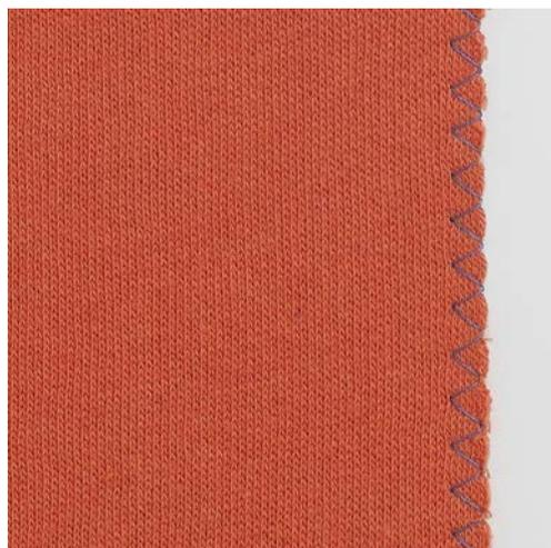
ジグザグ縫い。No. 2はすべての布地に適しています。また、伸縮性が必要なステッチや飾りステッチとしても使用できます。薄手の布地には縫い縫い用の糸を使用します。サテンステッチには振り幅が0.3-0.7 mmの目の詰まった短いジグザグ縫いが向いています。サテンステッチはアップリケや刺しゅうに使うことができます。
