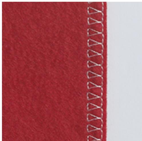
ダブルオーバーロックステッチは目の粗いニット地やジャージーに適しています。ニット地には、細かい編み目に穴を開けてしまわないよう、新しいジャージー針を使用することをお勧めします。伸縮性のある布地にはストレッチ針を使用します。
