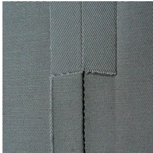
Тройная прямая строчка особенно подходит для износостойких швов и для жестких и плотных тканей, таких как джинсовая ткань и вельвет. При жестких или очень плотных тканях рекомендуется устанавливать Лапка для джинсовой ткани #8. Это облегчает работу с джинсовыми тканями или парусиной. Для декоративного простегивания можно дополнительно увеличить длину стежка.
