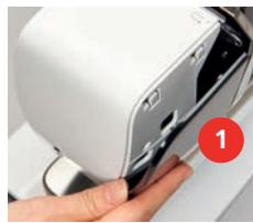
Поврежден шпульный колпачок. | > Замените шпульный колпачок.                                                                                                                                                                                       |
