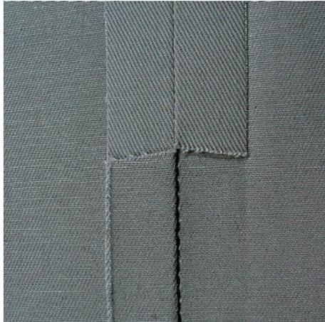
Der Dreifach-Geradstich ist besonders für strapazierfähige Nähte und für harte und dichte Stoffe wie Jeansstoff und Cordsamt geeignet. Bei harten oder sehr dicht gewobenen Stoffen empfiehlt es sich, den Jeansfuß #8 zu montieren. Dies erleichtert das Nähen von Jeansstoff oder Segeltuch. Für das dekorative Absteppen kann zusätzlich die Stichtlänge vergrößert werden.
