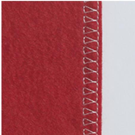
Eine Doppel-Overlocknaht eignet sich für lockere Maschenware und für Quernähte in Strickstoffen. Bei Maschenware sollte eine neue Jerseynadel verwendet werden, damit die feinen Maschen nicht beschädigt werden. Beim Nähen von elastischen Stoffen kann eine Stretchnadel verwendet werden.
