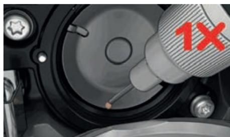
> Deite uma gota de óleo em cada um dos dois depósitos de óleo, de modo a molhar os feltros, e certifique-se de que a marca vermelha da manga da lançadeira permanece livre de óleo.
