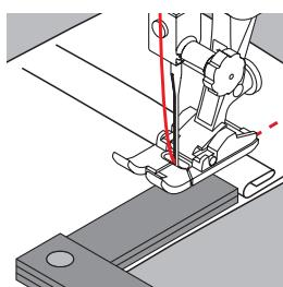
Для устранения наклона лапки при подходе к утолщению используйте одну, две или три компенсирующие пластины, располагая их за иглой под лапкой.
