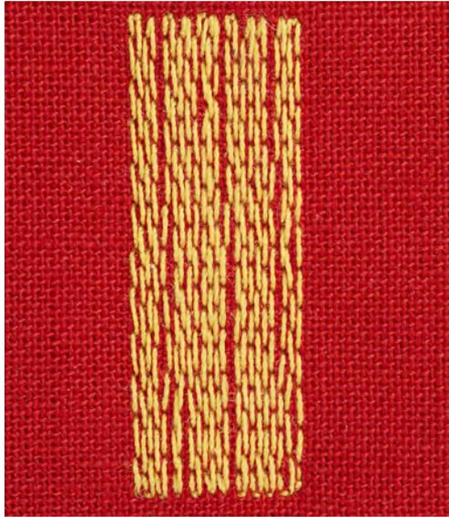
Le programme de reprise simple n° 22 convient surtout pour reprendre rapidement des endroits usés ou déchirés. Il est recommandé de renforcer les surfaces abîmées ou les déchirures avec un tissu fin ou de coller en dessous un non-tissé autocollant. Le programme de reprise simple n° 22 remplace les fils de chaîne dans tous les tissus. Si le tissu se déforme en biais, il est conseillé d'utiliser l'équilibrage.
