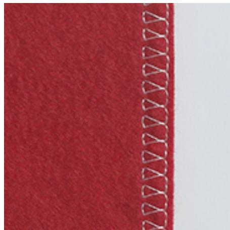
Lukket overlocksøm passer til løse strikkede stoffer og tversømmer i strikket stoff. En ny jerseyål bør brukes på strikkede stoffer, slik at ikke de fine maskene skades. En stretchnål kan brukes ved sying av elastiske stoffer.
