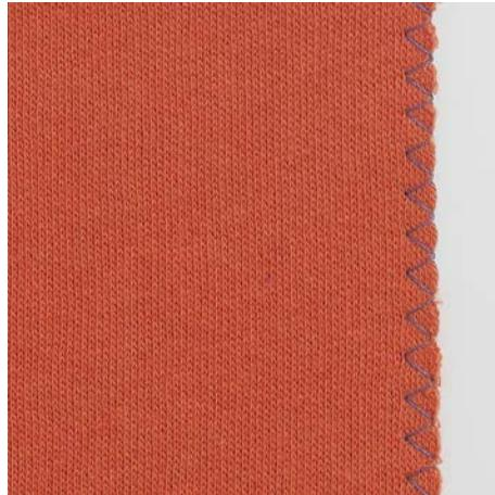
Sikksakk nr. 2 egner seg til alle stoffer. Den kan imidlertid også brukes til elastiske sørmer og dekorarbeider. Til fine stoffer bør det brukes stoppetråd. Til satengsøm anbefales det å stille inn en tett, kort sikksakksøm med stinglengde på 0,3 – 0,7 mm. Satengsøm kan brukes til applikasjoner og brodering.
