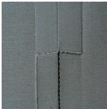
Forsterket rettsøm er en ekstra slitesterk sør og egnet for harde og tette stoffer som jeansstoff og cordfløyel. Ved harde og svært tettvevde stoffer anbefales det å montere Jeansfot #8. Den gjør det lettere å sy jeansstoff eller seilduk. For dekorative stikninger kan man i tillegg øke stinglengden.
