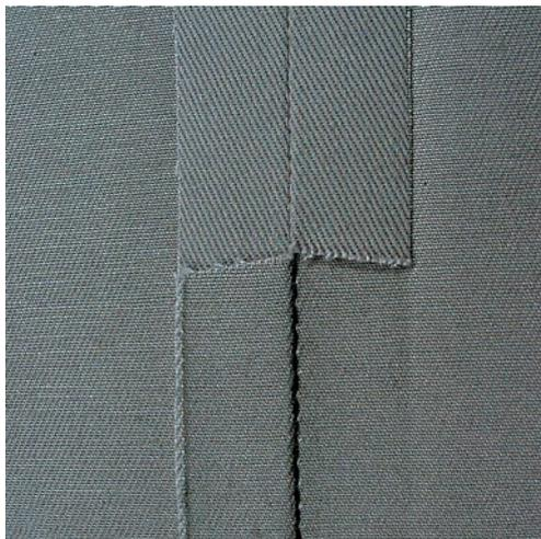
O Ponto reto triplo é especialmente adequado para costuras duráveis e para tecidos firmes e densamente trançados, como jeans e veludo cotelê. Para materiais firmes ou densamente trançados, recomenda-se ajustar o Calcador de Jeans #8. Isto irá ajudar na costura de brim ou lona. Para topstitching decorativo o comprimento do ponto pode ser alongado.
