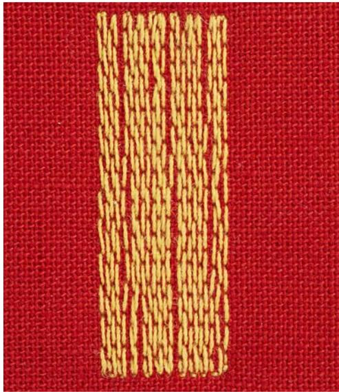
Простая программа штопки № 22 прежде всего подходит для быстрой штопки протертых мест или разрывов. Рекомендуется подклеивать под протертые места или разрывы легкую ткань или тонкую самоклеющуюся ткань. Простая программа штопки № 22 заменяет нити основы на всех материалах. Если поверхность штопки перекашивается, можно выровнять ее функцией баланса.
