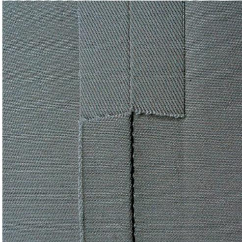
Der Dreifach-Geradstich ist besonders für strapazierfähige Nähte und für harte und dichte Materialien wie Jeansstoff und Cordsamt geeignet. Bei harten oder sehr dicht gewobenen Materialien empfiehlt es sich, den Jeansfuss Nr. 8 zu montieren. Dies erleichtert das Nähen von Jeansstoff oder Segeltuch. Für das dekorative Absteppen kann zusätzlich die Stichelänge vergrößert werden.
