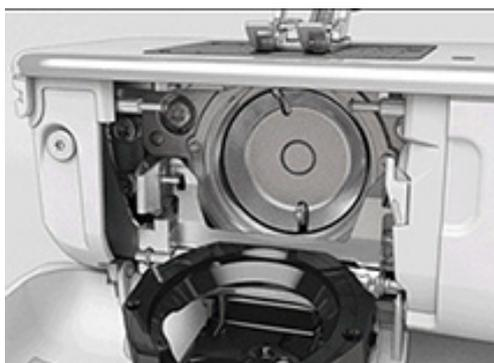
> BERNINA-Öl in die beiden Öldepots geben, sodass die Filze feucht sind und sicherstellen, dass die rot markierte Greiferhülsen-Fläche ölfrei bleibt.
