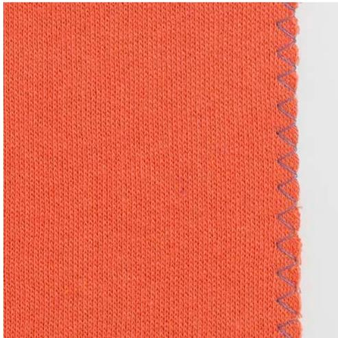
Der Zickzack Nr. 2 eignet sich für alle Stoffe. Er kann aber auch bei elastischen Nähten sowie auch für dekorative Arbeiten genutzt werden. Für feine Materialien sollte Stopffaden verwendet werden. Für die Raupennaht empfiehlt es sich, einen dichten, kurzen Zickzack mit einer Stichlänge von 0.5 – 0.7 mm einzustellen. Die Raupennaht kann für Applikationen und für das Sticken genutzt werden.
