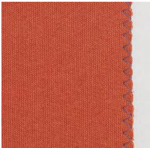
Der Zickzack Nr. 2 eignet sich für alle Stoffe. Er kann aber auch bei elastischen Nähten sowie auch für dekorative Arbeiten genutzt werden. Für feine Stoffe sollte Stopffaden verwendet werden. Für die Raupennaht empfiehlt es sich, einen dichten, kurzen Zickzack mit einer Stichlänge von 0,3 – 0,7 mm einzustellen. Die Raupennaht kann für Applikationen und für das Sticken genutzt werden.
