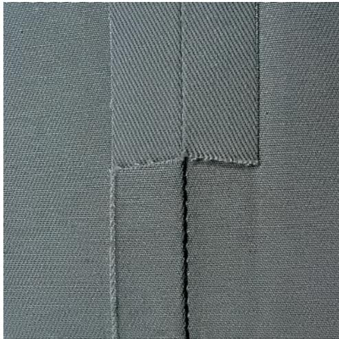
Der Dreifach-Geradstich ist besonders für strapazierfähige Nähte und für harte und dichte Stoffe wie Jeansstoff und Cordsamt geeignet. Bei harten oder sehr dicht gewobenen Stoffen empfiehlt es sich, den Jeansfuß Nr. 8 zu montieren. Dies erleichtert das Nähen von Jeansstoff oder Segeltuch. Für das dekorative Absteppen kann zusätzlich die Stichlänge vergrößert werden.
