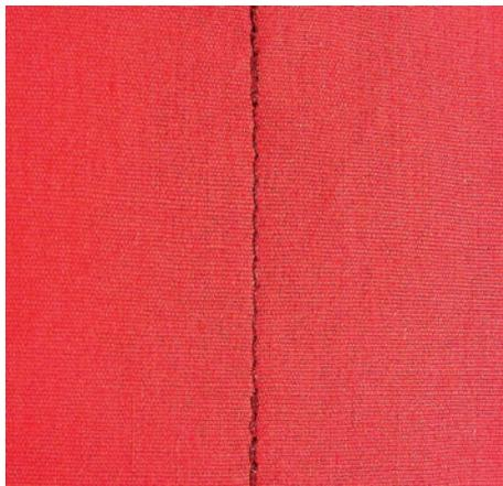
Durch eine definierte Stichzahl von 6 vorwärts genähten und 6 rückwärts genähten Stichen wird gleichmässig vernäht.
