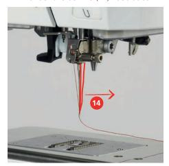
> Pasar el hilo por debajo del prensatelas y de atrás hacia adelante por el corta-hilos (15) y cortar.
