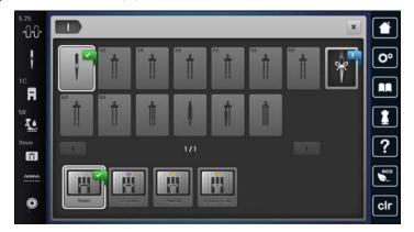
Si la aguja seleccionada es adecuada para el prensatelas seleccionado, es posible empezar a coser. Si la aguja seleccionada no es adecuada para el prensatelas seleccionado, al iniciar la máquina se muestra un mensaje de error y la máquina no arranca.
