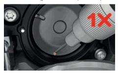
> Poner una gota de aceite para máquinas de coser BERNINA en cada uno de los dos depósitos de aceite hasta que los fieltros estén húmedos y asegurarse de que la superficie de la lanzadera marcada en rojo esté libre de aceite.
