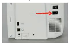
> Insertar el enchufe del cable de la red en la toma de corriente.
