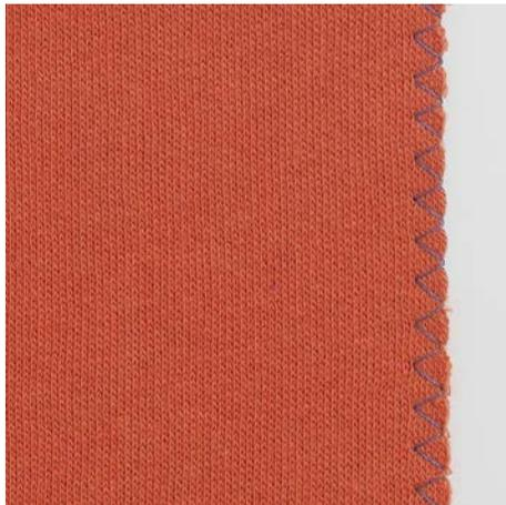
Zickzack Nr. 2 eignet sich für alle Stoffe. Er kann aber auch bei elastischen Nähten sowie auch für dekorative Arbeiten genutzt werden. Für feine Stoffe sollte Stopffaden verwendet werden. Für die Raupennaht empfiehlt es sich, einen dichten, kurzen Zickzack mit einer Stichlänge von 0,3 – 0,7 mm einzustellen. Die Raupennaht kann für Applikationen und für das Sticken genutzt werden.
