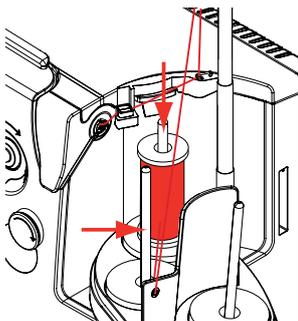
Es können beide Garnrollenstifte (mit Pfeilen markiert) verwendet werden, aber wegen dem bessern Abzugswinkel ist die hintere Position am Besten geeignet. Der Stift der Spulerposition sollte nicht verwendet werden.
