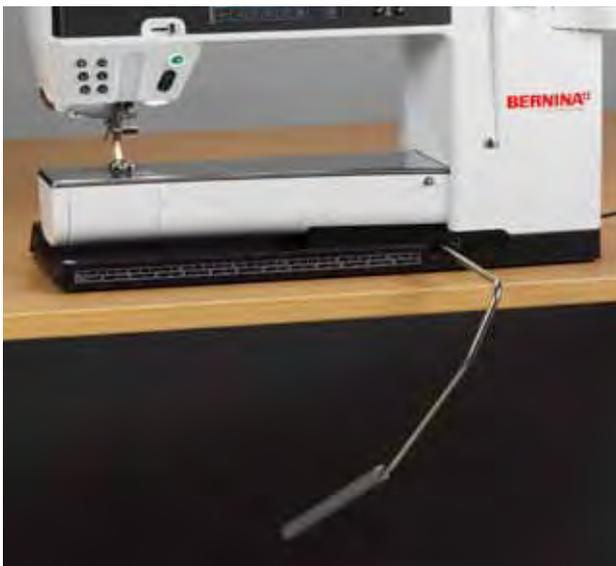
Der Kniehebel dient zum Heben und Senken des Nähfusses.
