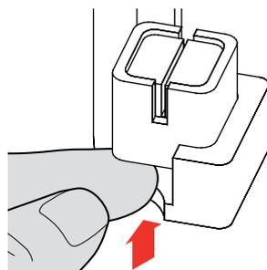
Bei Anwendung der Einheit als Umlenköse, muss die Schmiereinheit entfernt werden. Dazu die Einheit vom Nähcomputer entfernen.
