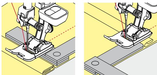
Для устранения наклона лапки при подходе к утолщению используйте одну, две или три компенсирующие пластинки, располагая их за иглой под лапкой.
