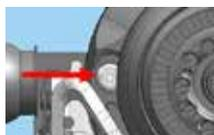
После смазки установите челнок в указанное на картинке положение, поворачивая маховое колесо по часовой стрелке (см. рис. слева), чтобы правильно заправить нитку.
