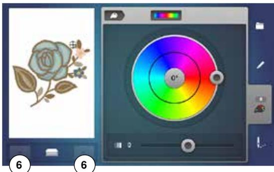
При комбинации образцов можно нажатием кнопок **6** «вверх/вниз» в левой части дисплея прокрутить комбинацию и так изменить цвет каждого отдельного образца.
