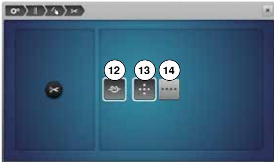
Можно запрограммировать число и тип закрепляющих стежков перед обрезкой нитки.
