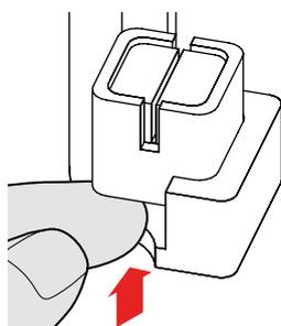
Если вы используете устройство без смазки, то есть – просто как нитенаправитель, снимите блок смазки.
