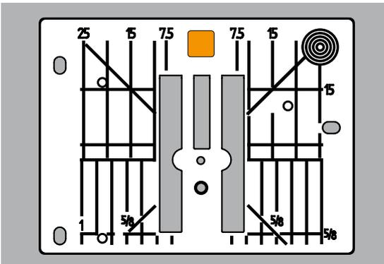
Игольная пластина для прямых стежков имеет круглое игольное отверстие, в которое проходит только игла, и благодаря этому обеспечивается оптимальная вязка стежков и получается более красивый рисунок строчки и вышивки. Игольная пластина CutWork имеет большое круглое игольное отверстие, в которое проходит специальная игла для вырезания форм.
