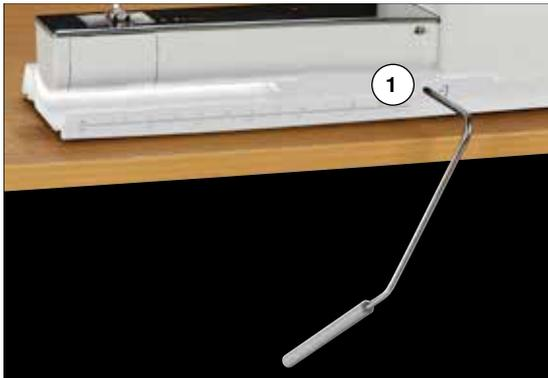
Лапка поднимается или опускается коленоподъемником.
