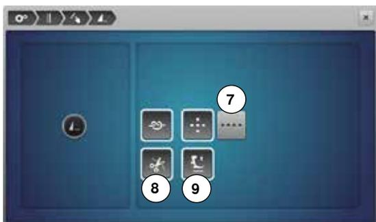
Число и тип закрепляющих стежков кнопки «Конец образца/закрепление строчки» на передней панели машины можно запрограммировать.
