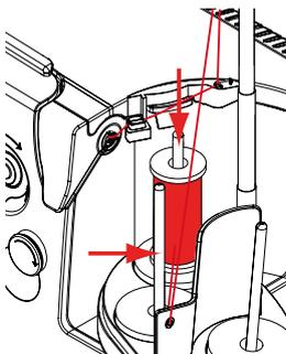
Можно использовать любой из двух стержней катушкодержателя, указанных на рисунке стрелками. Тем не менее, предпочтительно использовать именно задний стержень катушкодержателя, поскольку он имеет более подходящий для разматывания ниток наклон. Не следует использовать стержень моталки.
