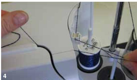
из-за более сильного сопротивления при радиальной размотке ниток, необходимо размотать дополнительный объем ниток с катушки при заправке нитки (рис. 4). Этот запас ниток гарантирует, что автоматическая заправка будет выполнена корректно.
