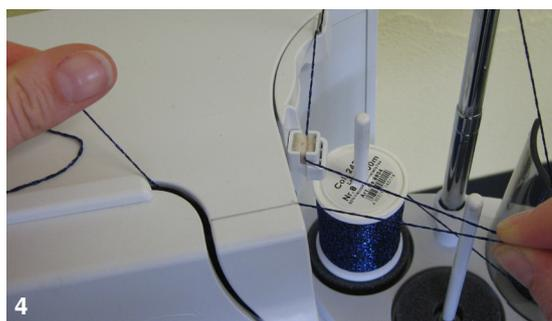
En raison de la résistance du déroulement radial du fil, il faut tirer un peu plus de fil de la bobine. Ce supplément de fil garantit un enfilage automatique correct (ill. 4).
