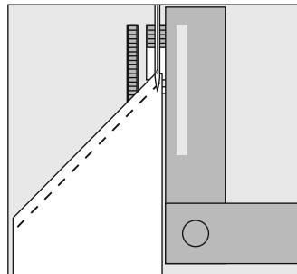
Если уложить с правой стороны лапки одну или несколько пластинок вплотную к краю материала, то подача транспортера будет более равномерной.
