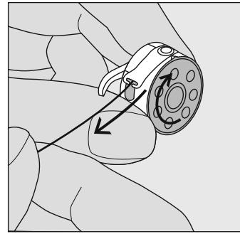
..... чтобы она вошла в Т-образную прорезь на конце пружинки. Шпулька должна вращаться по часовой стрелке.
