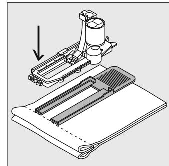
Если петля должна быть расположена под прямым углом к кромке материала, рекомендуется использовать пластину для компенсации утолщений материала (приобретается в качестве дополнительной принадлежности). Эту пластину вставьте сзади между материалом и подошвой лапки с салазками и придиньте вплотную к утолщению материала.
