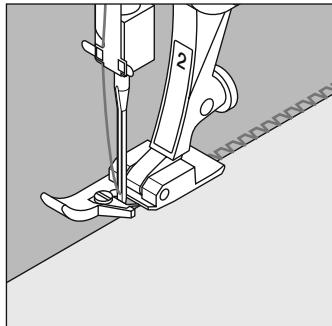
Оверлочная лапка № 2 специально предназначена для шитья оверлочных стежков. Эта лапка позволяет вшивать в шов достаточно большое количество нитки, что обеспечивает эластичность шва.
