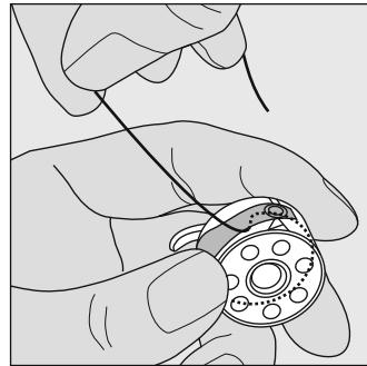
Затягивание нитки под пружинку
