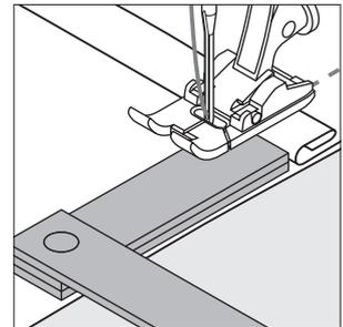
Zum Ausgleichen der Nahthöhe vor dem Nähfuss ein oder mehrere Plättchen auf der rechten Seite des Nähfusses bis dicht an die Nadel legen. Nähen bis der ganze Nähfuss die dicke Nahtstelle passiert hat, Plättchen entfernen.
