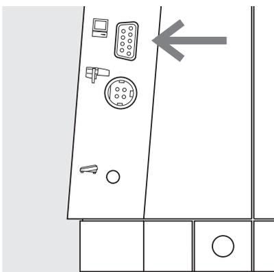
**Verbindungskabel vom PC an den Nähcomputer stecken**
