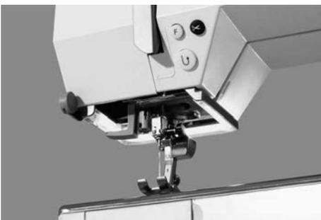
Das CFL-Nählicht zeichnet sich – im Gegensatz zu einer herkömmlichen Glühlampe – durch eine bessere Ausleuchtung des Nähbereiches sowie durch eine sehr hohe Lebensdauer aus.
