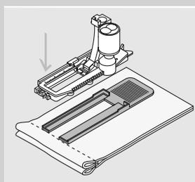
Per cucire un'asola orizzontalmente sul bordo dell'indumento, si consiglia l'uso del compensatore per il piedino a slitta (accessorio opzionale). Inserire il compensatore da dietro tra indumento e piedino e posizionarlo fino allo spessore più alto. Così il piedino deve superare nessun «scalino».
