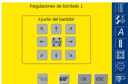
EL ajuste del bastidor es la coordinación de la aguja con el centro del bastidor. El ajuste sólo se puede ejecutar con el módulo para bordar y el bastidor ovalado montado. Sólo se tiene que hacer una vez porque vale igualmente para todos los tamaños de bastidores.
