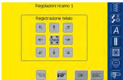
La regolazione del telaio imposta l'ago nel centro del telaio. Può essere effettuata solo quando il modulo di ricamo è collegato.
