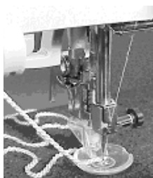
43 フリーハンドカウチング押え コードやリボンなどをフリーハンドでカウチングできます。
