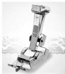
10/10C 端縫い押え 布端やへり、プリーツなどを縫うときにガイド板が役に立ちます。またリボンやレース、キルト芯などをつき合わせて縫うときに使います。
