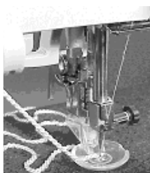
43 Calçador para movimento livre Costura reta • Costurar cordões com efeitos de curvas
