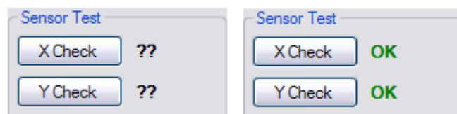
Для проверки работы датчиков по осям, нажмите соответствующую кнопку (X-Check; Y-Check). Если датчики успешно распознаются, появится сообщение **OK**.
