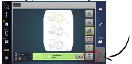
3) Der Stickrahmen wird in die Nähe des letzten Stiches verschoben. Mit den Multifunktionsknöpfen kann die horizontale und vertikale Position der Nadel im Stickrahmen eingestellt werden, bis die Nadel über einem der Referenzpunkte steht.
