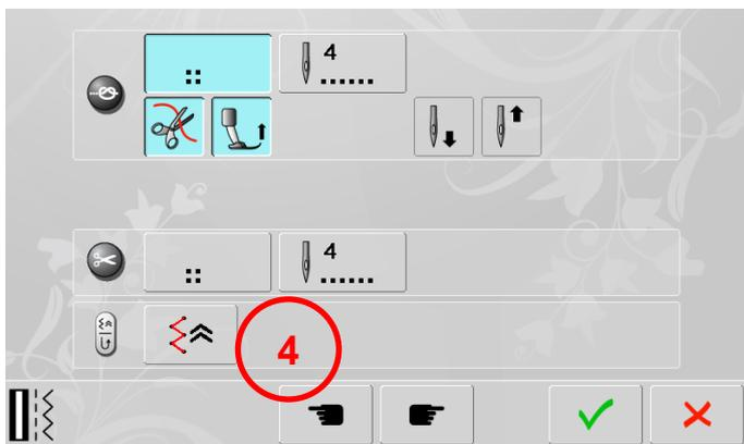
La couture en marche arrière point par point est toujours désactivée (réglage d'usine) et peut être activée ou de nouveau désactivée dans le Setup (point 4).
