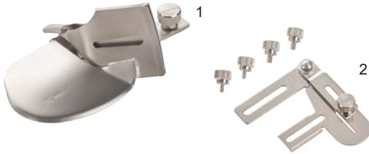
Con il bordatore doppia piega si possono rifinire perfettamente bordi in stoffa e scollini. Il nastro senza piega viene inserito attraverso il binario di guida, piegato sui lati superiore e inferiore del nastro in sbieco e cucito con un punto di copertura o catenella. Per un look personalizzato, il nastro può essere tagliato anche da soli.
