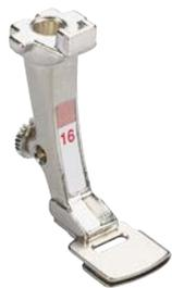
È adatto per arricciare strati singoli di stoffa o per arricciare uno strato di stoffa e cucirlo contemporaneamente su un pezzo di stoffa che rimane liscio. La stoffa sottile o di pesantezza media viene trasportata in modo non uniforme e prende così la caratteristica arricciata.
