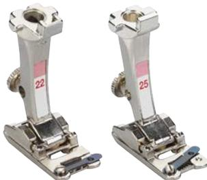
Le scanalature consentono l'applicazione contemporanea di più fili o nastri stretti paralleli, che vengono mantenuti in posizione dalla linguetta apribile. Pertanto non è più necessaria una guida per i fili. Il piedino #22 serve per la lavorazione di tre fili paralleli, il piedino #25 per quella di cinque fili paralleli.
