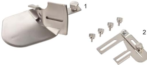
Con il bordatore piega semplice si possono rifinire perfettamente con nastro bordi in stoffa e scollini. Il nastro senza piega viene inserito attraverso il binario di guida, piegato sul lato superiore mentre il lato inferiore rimane aperto e cucito con un punto di copertura. Per un look personalizzato, il nastro può essere tagliato anche da soli.
