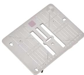
Questa placca ago ha una marcatura lilla e un'apertura del foro di 5,5 mm. Si utilizza sulle macchine con la larghezza punto di 9 mm e consente di ottenere risultati particolarmente buoni quando si cuciono stoffe sottili o morbide. Per lavori di cucito ricchi di dettagli possono essere utilizzati tutti i punti decorativi e a zigzag larghi fino a 5,5 mm.
