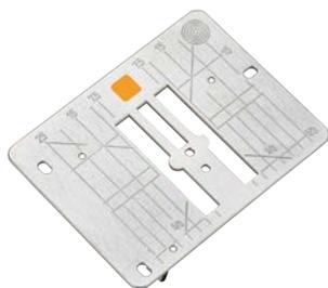
La placca ago per punto diritto e CutWork ha una marcatura arancione. Può essere utilizzata per lavori di ricamo, lavori a punto diritto ma anche per lavori da eseguire con lo strumento CutWork e CrystalWork. In combinazione con i piedini con apertura piccola, garantisce la massima perfezione del punto diritto. Rientrano in questa categoria i piedini i #8, #26, #53, #62 e #64.
