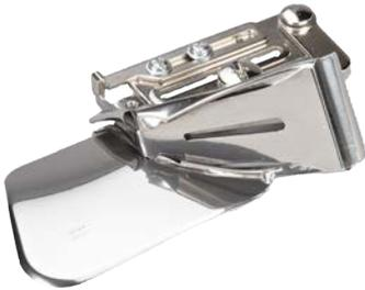
Il bordatore consente di rifinire i bordi con nastri in sbieco non piegati larghi 28, 32 e 38 mm. Per il look perfetto, puoi realizzare il nastro in sbieco con la stoffa di tua scelta. Nastri da 28, 32 e 38 mm di larghezza danno come risultato una larghezza finita di circa 7, 8 e 11 mm. Il bordatore viene utilizzato insieme al piedino per bordare #95/95C.
