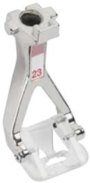
Эта лапка подходит для простого пришивания узкого гладьевого валика до 2 мм. Прозрачная подошва лапки особой формы обеспечивает прекрасную видимость области шитья и беспрепятственно перемещает плотно сшитые строчки - как прямые линии, так и извилистые. В углубление на передней стороне лапки можно дополнительно вложить вкладную нить или тесьму.
