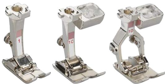
Лапка для реверсных стежков пригодна для выполнения различных рабочих и декоративных строчек, а также для шитья подрубленных краев. Свободное место для нитки перед прорезью игольной пластины и за нею дает возможность выполнять образцы с попеременным движением материала вперед и назад и гарантирует прекрасную подачу материала.
