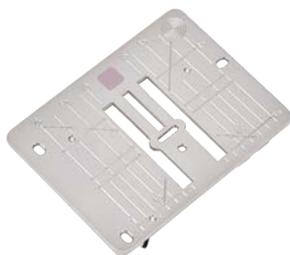
Эта игольная пластина имеет фиолетовую маркировку и уменьшенную ширину прорези 5,5 мм. Она подходит ко всем 9 мм машинам и обеспечивает особенно хорошие результаты шитья при работе с тонкими или мягкими тканями. Для более детальных швейных работ можно использовать все строчки зигзаг и декоративные строчки при максимальной ширине строчки 5,5 мм.
