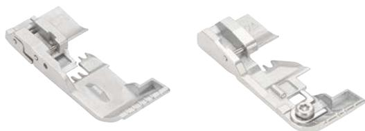
Лапка для рюшей #C24 создана для рюшей и сборок на тонких, мягких, однослойных тканях и обеспечивает равномерную подачу ткани. Эта лапка подходит для всех оверлочных, плоских, цепных и комбинированных строчек.
