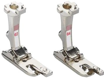
При использовании игольной пластины для прямых стежков с этим подрубателем получается тонкий подрубочный шов и очень красивый стежок. Материал при шитье в ходе одной операции подгибается вдвое и прошивается прямой строчкой. Лапки #62 и #64 используются для подрубочных швов шириной соответственно 2 или 4 мм.
