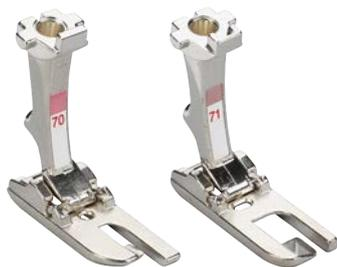
Эта лапка позволяет выполнять точные запошивочные швы. Поскольку припуски на шов полностью включаются в подрубочный шов, они пригодны также для одежды, которую можно носить с двух сторон. Лапка #70 подходит для запошивочных швов шириной до 3 мм, лапка #71 для запошивочных швов шириной до 6 мм.
