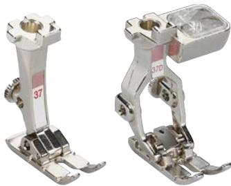
Эта лапка идеальна для выполнения пэчворка с припуском на шов 3 мм (1/8 дюйма) или 6 мм (1/4 дюйма). Три боковые маркировки служат оптимальной ориентацией для углового применения частей пэчворка.
