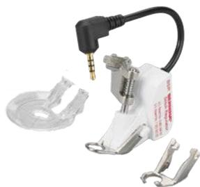
Идеальная лапка для свободной машинной стежки с регулируемой длиной стежка на всех видах материалов. Она реагирует на движение ткани и регулирует скорость иглы при свободном шитье. Установленная длина стежка сохраняется независимо от движения ткани, что способствует получению абсолютно равномерной строчки.
