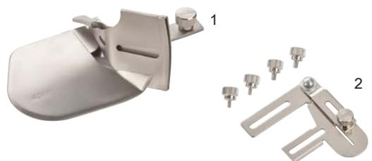
С устройством для окантовки срезов косой бейкой можно отлично окантовывать тесьмой канты материала и горловины. Нефальцованная тесьма проводится через закрепленную направляющую линейку, заворачивается на верхней стороне, в то время как нижняя сторона остается открытой, и пришивается плоским швом. Для индивидуального вида можно покроить бейку самостоятельно.
