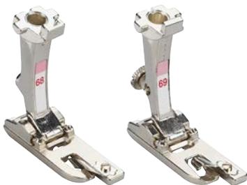
Эта лапка идеальна для подрубки мягких материалов, таких как трикотаж. Материал при шитье в ходе одной операции вдвое подгибается и прошивается оверлочной строчкой. При этом образуется тонкий и прочный фестончатый подрубленный край. Лапки #68 и #69 используются для подрубочных швов шириной соответственно 2 или 4 мм.
