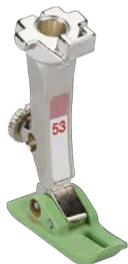
В сочетании с игольной пластиной для прямых стежков эта лапка отлично подходит для всех работ прямой строчкой и для узких швов. Благодаря подошве с покрытием против прилипания она легко шьет ткани с плохим скольжением, такие как кожа, синтетика или похожие материалы. Оба пальца лапки разной ширины служат одновременно и в качестве направляющих линий для припусков на шов в 3 и 6 мм.
