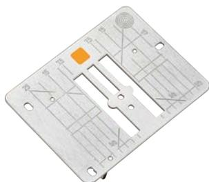
Игольная пластина для прямой строчки и работы с CutWork имеет оранжевую маркировку. Ее можно использовать для работ прямым швом и вышивания, а также для работ с CutWork и CrystalWork. При использовании ее в комбинации с лапками, имеющими маленькое отверстие, обеспечивается совершенная вязка стежков прямой строчки. Это касается лапок #8, #26, #53, #62 и #64.
