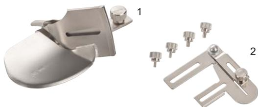
С устройством для окантовки срезов вдвое сложенной косой бейкой можно отлично окантовывать тесьмой канты материала и горловины. Нефальцованная тесьма проводится через закрепленную направляющую линейку, заворачивается на верхней и нижней стороне косой бейки и пришивается плоским или цепным швом. Для индивидуального вида можно покроить бейку самостоятельно.
