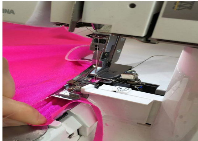
Stabilität erhält der Wellencharakter eines Rollsaumes durch Einnähen einer Angelschnur
