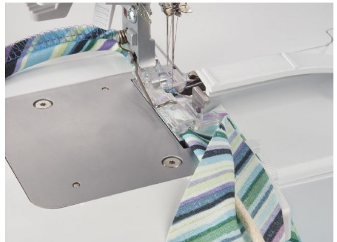
Verwenden Sie die 3-Faden Overlocknaht und den Paspel/Perlenfuß um Paspeln zu erstellen
