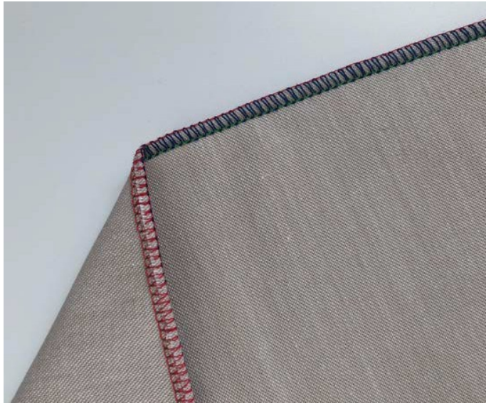
Mit der 3-Faden-Rollnaht erhalten Sie einen schönen und sicheren Kantenabschluss bei feinen Stoffen
