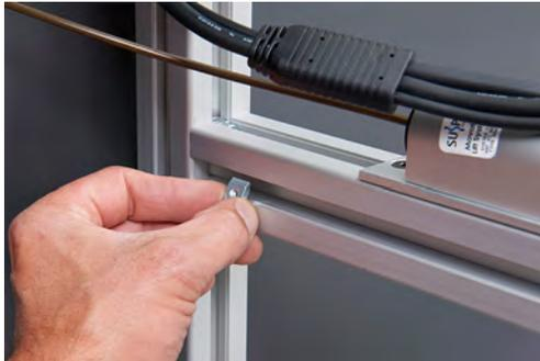
> 1 Zylinderschraube (S2) in die Aufhängevorrichtung der Motorsteuerung einfügen und im Nutenstein des Beinelements festschrauben. Die Motorsteuerung so montieren, dass die elektrischen Anschlüsse in der Nähe der Pumpenkabel sind.
