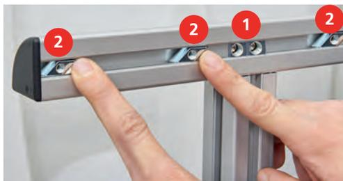
> Beim Hubzylinder an der oberen Seite (1) eine Halteplatte mit 2 Senkschrauben (S3) montieren.
