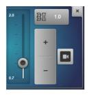
Die beiden Stofftransporteure können beim Nähen so aufeinander abgestimmt werden, dass der Stoff gleichmässig transportiert wird und es zu keiner Wellenbildung oder unerwünschtem Kräuseln kommt.
