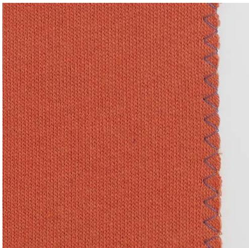
Le point de zigzag n° 2 convient pour tous les tissus. Il peut aussi être utilisé pour des coutures élastiques et des travaux décoratifs. Utiliser un fil fin de reprises pour les tissus fins. Pour la couture chenille, il est recommandé de régler un zigzag court dense d'une longueur de 0,3 à 0,7 mm. La couture chenille peut être utilisée pour les appliqués et pour la broderie.
