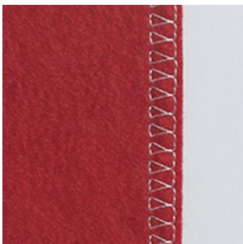
Le surjet double s'adresse aux coutures élastiques sur des tissus fins et souples et les coutures transversales sur les tricots. Avec un tricot, il est conseillé de choisir une aiguille pour jersey qui n'abîmera pas les mailles. On préférera une aiguille stretch pour la couture des tissus élastiques.
