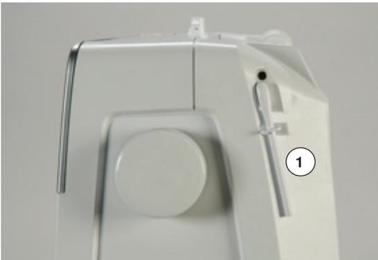
Le support de bobine vertical se trouve de côté derrière le volant. Indispensable pour la couture avec plusieurs fils, par ex., avec une aiguille jumelée, ainsi que pour le bobinage pendant la couture.
