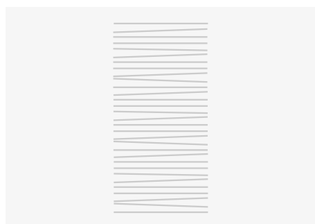
Työn vetäminen tai työntäminen aiheuttaa ompeleen kasaantumisen ja ompeleesta muodostuu epätasainen.
