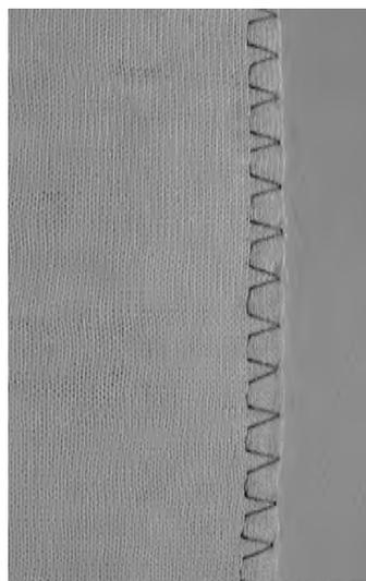
Il piedino n. 2 è stato sviluppato appositamente per i punti overlock. Il punto viene formato intorno alla staffetta del piedino, tenendo piatto il bordo della stoffa e garantendo l'elasticità del punto.
