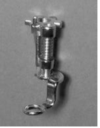
9 Yamama ayağı Yama, monogramlar ve serbest ek nakış işleri için alçaltılmış pozisyonda besleme mandalı ile birlikte kullanılır
