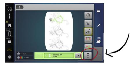
3) Пяльцы сместятся к последнему вышитому стежку. С помощью многофункциональных элементов управления можно установить позицию иглы над пяльцами по вертикали и горизонтали так, чтобы игла оказалась точно над контрольной точкой.
