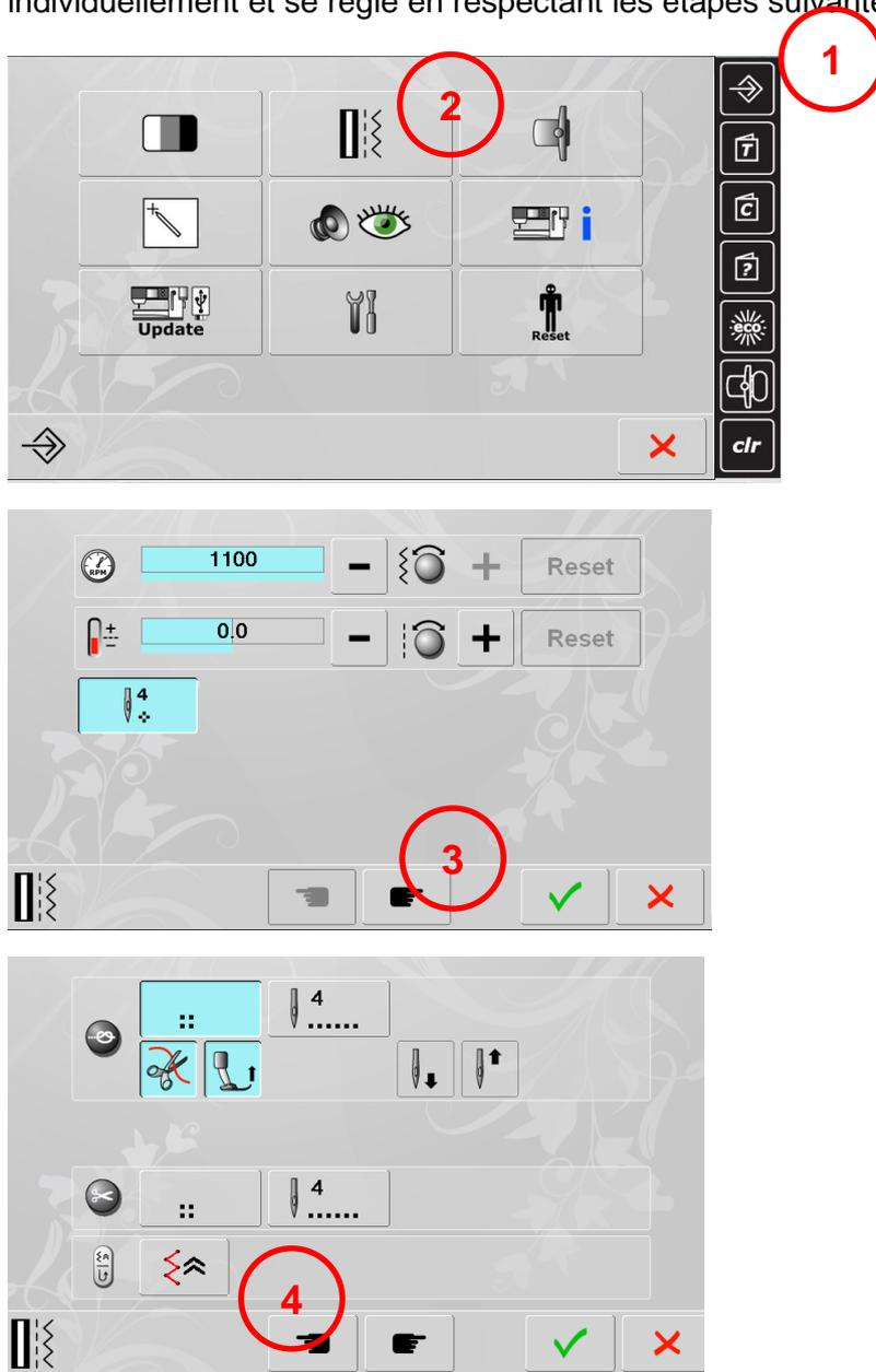
La couture en marche arrière point par point est toujours désactivée (réglage d'usine) et peut être activée ou de nouveau désactivée dans le Setup (point 4).
